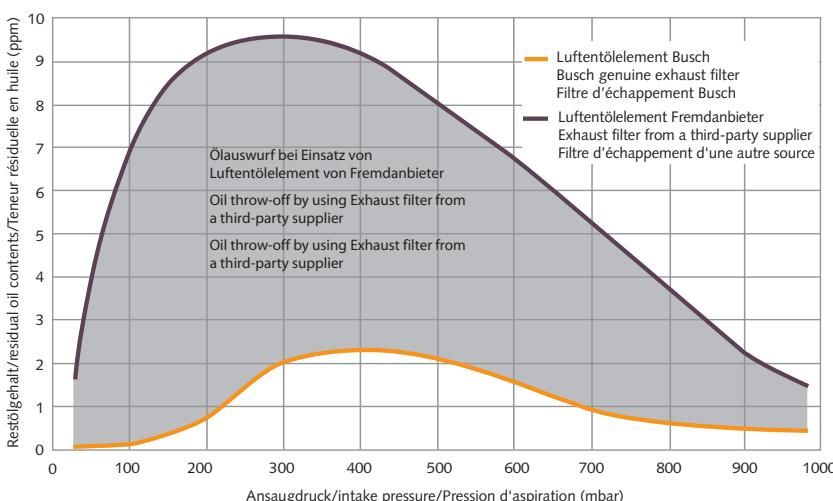
Bei 100 mbar enthält die Abluft des getesteten Luftentölelements eines Fremdanbieters mehr als die 30-fache Anzahl von Ölpartikeln eines Original Busch Luftentölelements!
